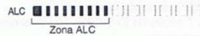
Ajustar [COMP GAIN] de manera que el medidor ALC lea en la zona ALC
